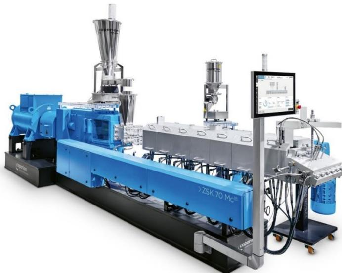
ZSK-Doppelschneckenextruder von Coperion sind mit zahlreichen Features ausgestattet, die das hocheffiziente Compoundieren von Kunststoffen sicherstellen.
