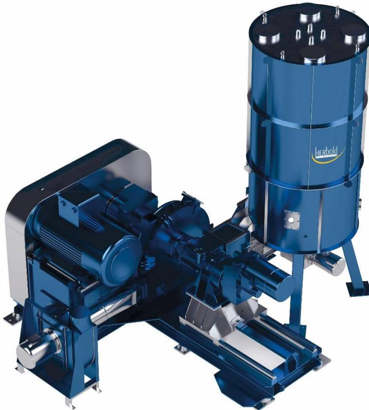
Der Plastkompaktor HV 70 ist der leistungsstärkste der Baureihe von Herbold Meckesheim. Er verarbeitet das Ausgangsmaterial im kontinuierlichen Betrieb zwischen einem rotierenden und einem feststehenden Verdichtungsteller, die mit aufgeschraubten und leicht austauschbaren Knetleisten ausgestattet sind.
