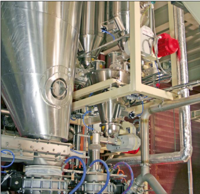
Dosierer von Coperion K-Tron in einem Tiernahrungs-Beschichtungsprozess
