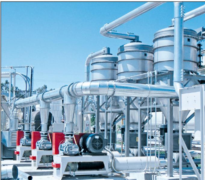
Entladung eines Silos für mehrere Schüttgüter
