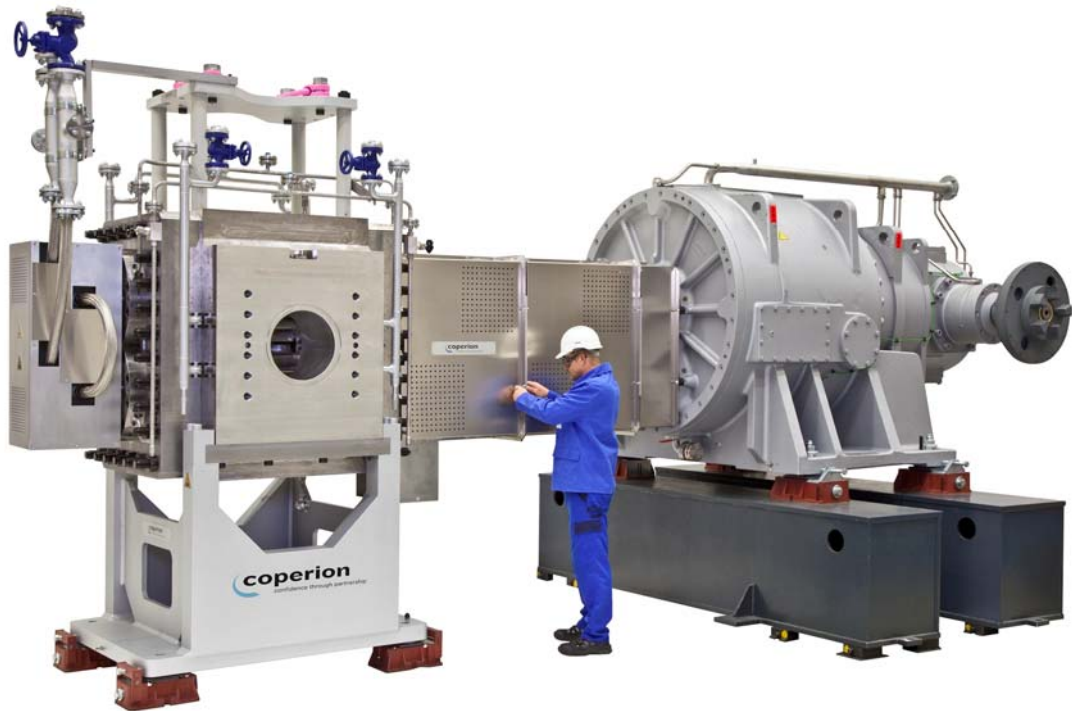
MP450是科倍隆生产的至今为止最大的熔体泵，生产聚烯烃的产量可达65吨/小时。 照片： 科倍隆，斯图加特
